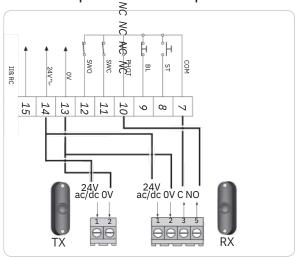
Sur la cellule, mettre le dips@itch1 et le dipswitch2 sur ON.
